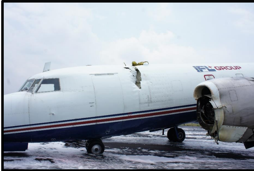
Fotografía No. 3 Motor Izquierdo sin la hélice y daño severo.
