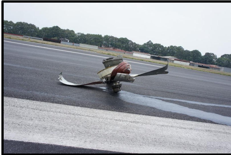
Fotografía No. 11 Vista de la hélice izquierda.
