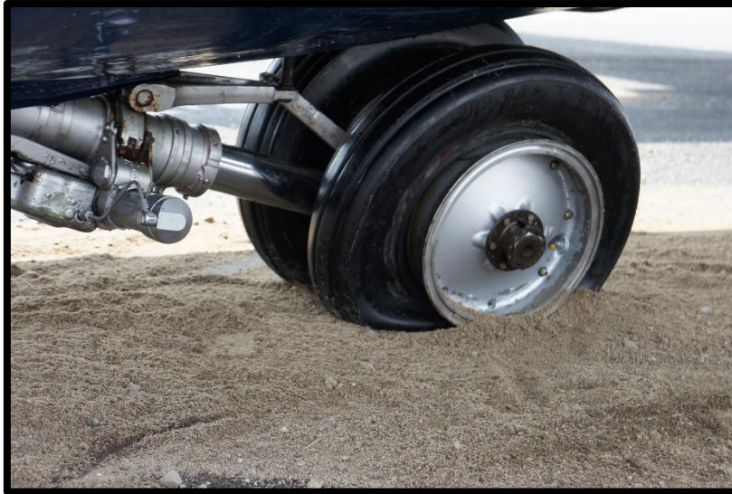
Fotografía No. 9 Vista de llanta del Tren de Nariz llanta con daños.
