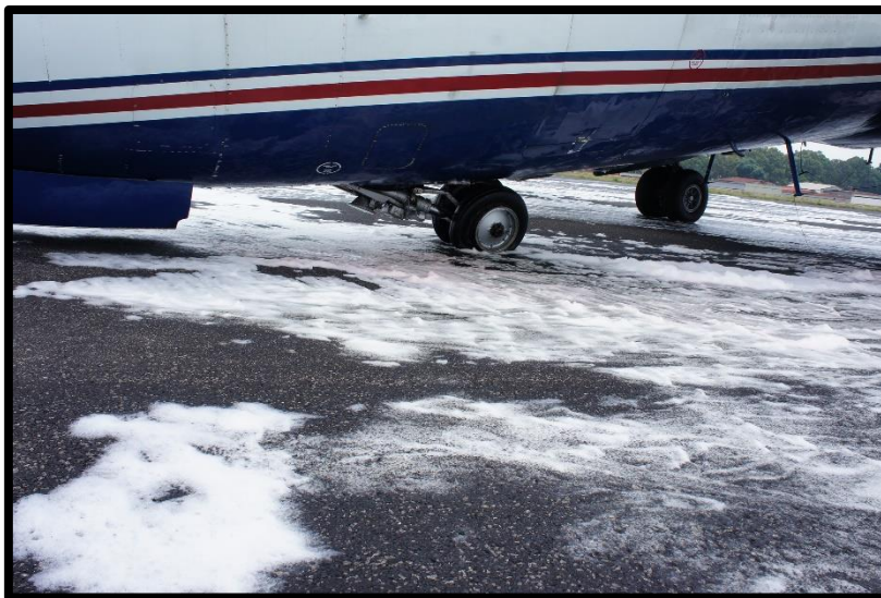
Fotografía No. 4 Tren de nariz dañado desde su base e inclinado hacia atrás.
