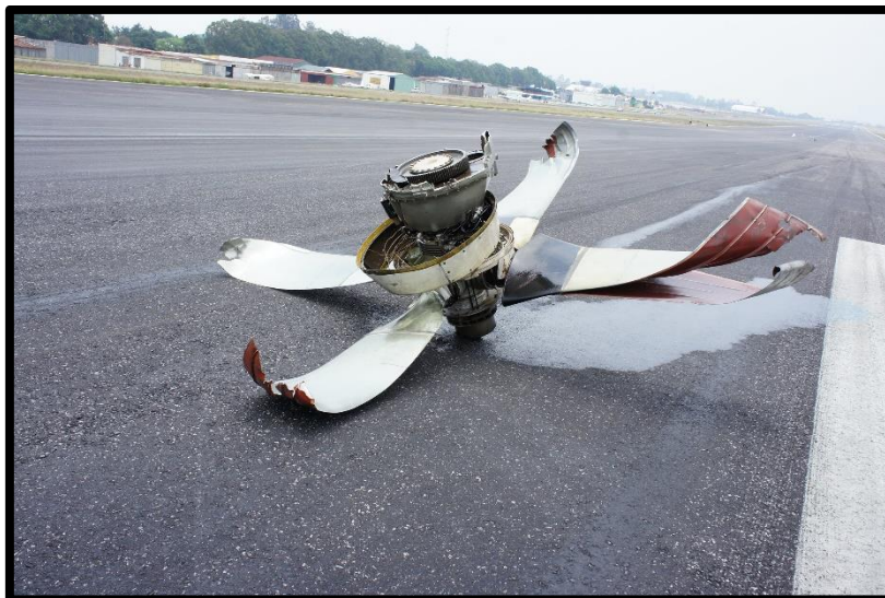
Fotografía No. 12 Vista cercana de la hélice izquierda desprendida por los golpes con el pavimento.
