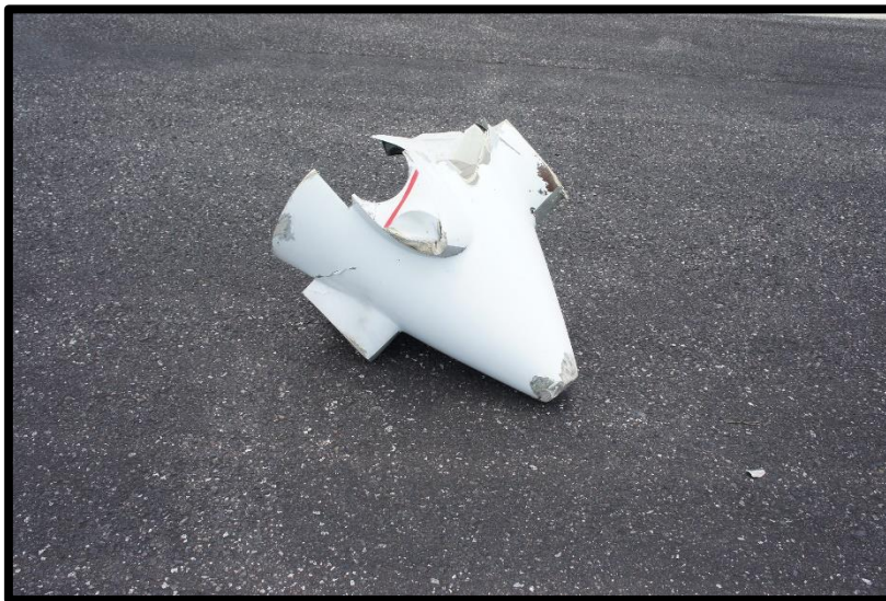
Fotografía No. 10 Cobertor (Speener) del Domo de la hélice derecha.
